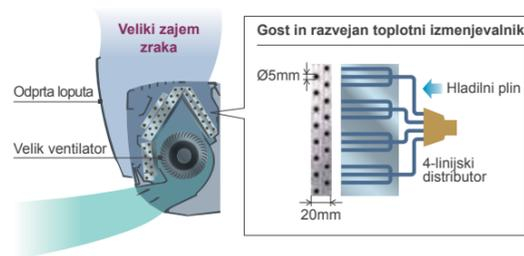
**Zunanja enota** vsebuje velik toplotni izmenjevalnik ter dvojni DC rotacijski kompresor, kar omogoča še večjo učinkovitost visoke kapacitete delovanja. Z učinkovito strukturo za pretok zraka se zmanjša hrup ob delovanju naprave.
