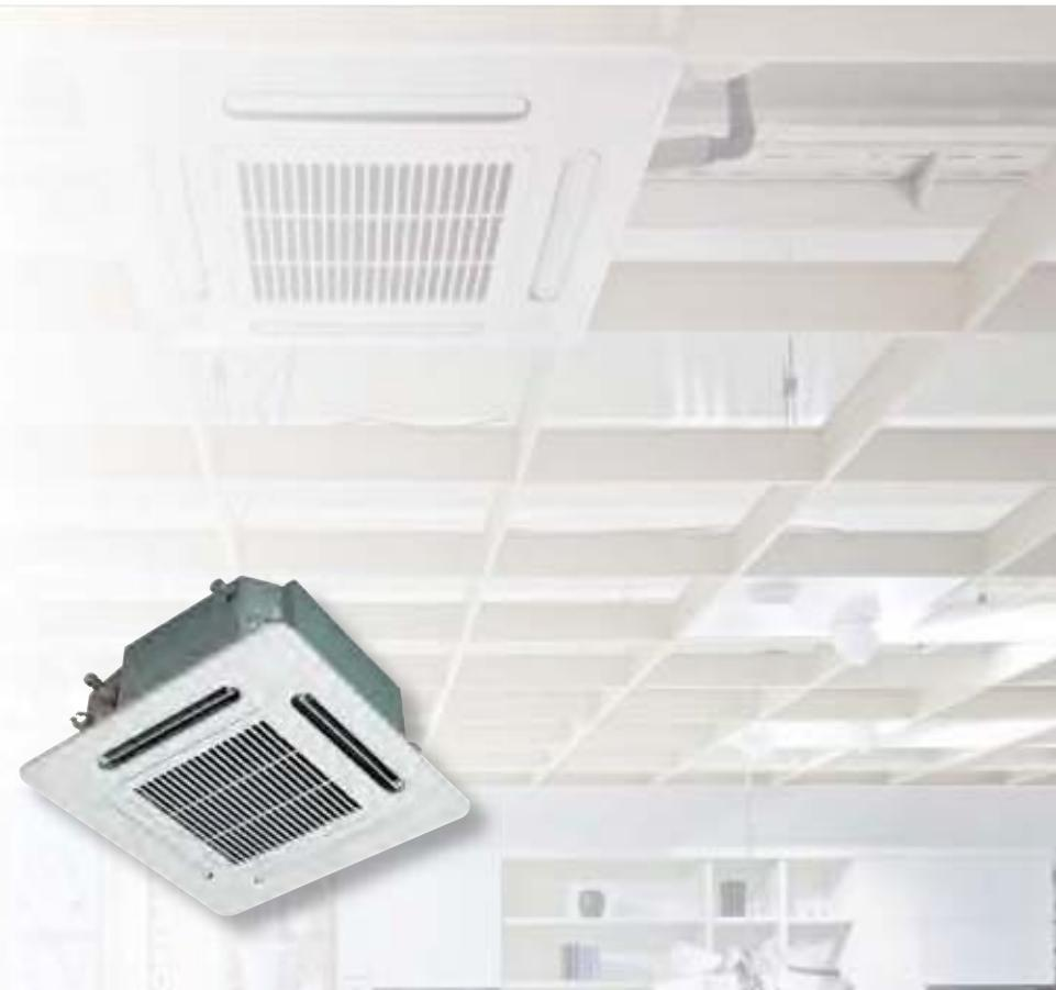
■ Evro-Raster kaseta z 4 odprtinami za izhod zraka zaradi svojih dimenzij predstavlja kompaktno napravo z 575 x 575 mm, kar je idealna rešitev za vse standardne evroraster stropove. Zaradi novo razvitega turbo aksialnega ventilatorja je naprava zelo tiha; razen tega dizajn zračnega izpusta preprečuje nabiranje prahu na stropu.
