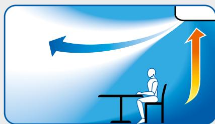
Pri stropnih napravah se lahko zračni tok nastavi s pomočjo lamel za usmerjanje zraka tako, da zrak kroži nad osebo.
